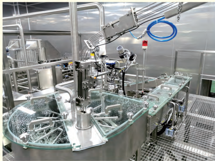
瓶盖经瀑布式盖提升系统将瓶盖提升送至盖消毒清洗槽，经无菌水浸泡及无菌水喷射后经送盖滑道送入无菌主机进行旋盖包装。
